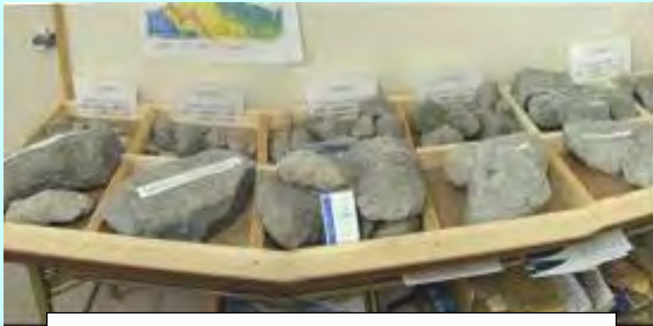
砂岩の礫: 一軸強度 = 70~80MPa
